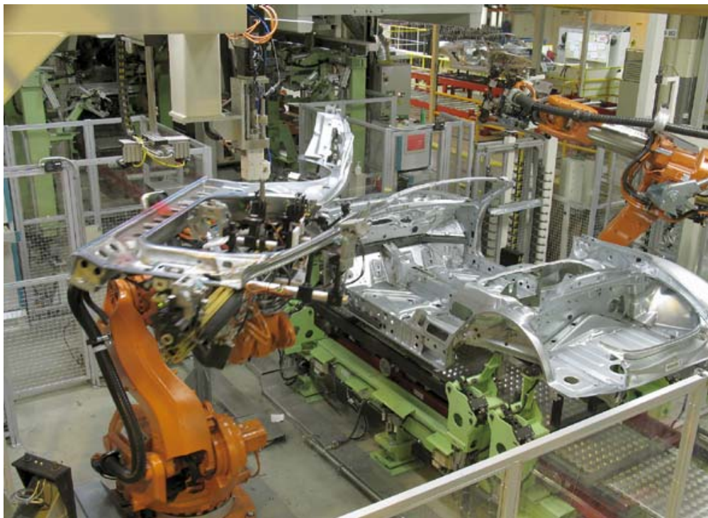
Tuotantotekniikkaa pitkälle automatisoidussa korihitsaamossa
